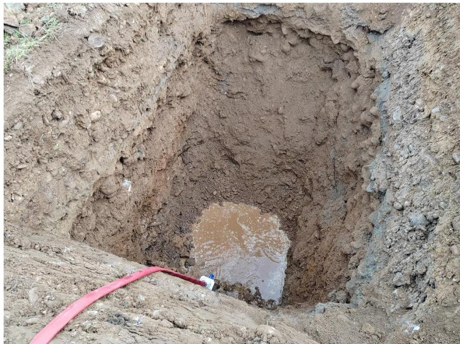
Abbildung 2: Baggerschlitz BS 23-1/VS mit Versickerungsversuch, Tiefe ca. 4 m ab OK Terrain
